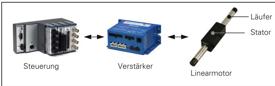
Bild 3: Das cRIO-System (links) steuert über einen Verstärker den Linearmotor.
